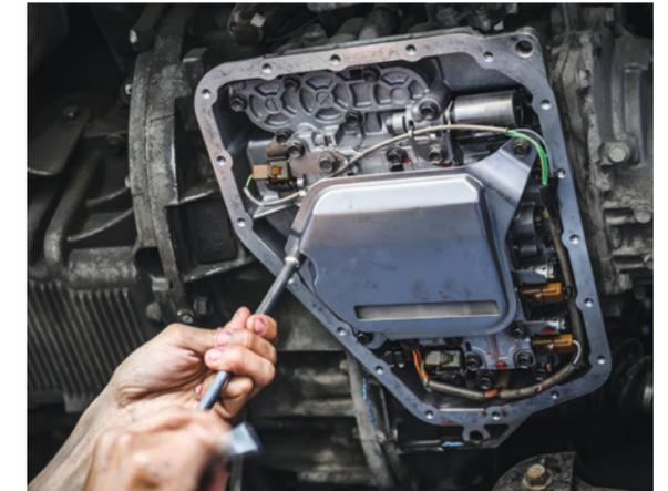
Je nach Getriebe kommen Saug- und/oder Druckölfilter zum Einsatz. Automatikgetriebe sind in der Regel mit Saugfiltern ausgestattet. Diese befinden sich als kompakte Flachfilter in einem Vollkunststoffgehäuse direkt in der Ölwanne. Für den Wechsel eines Saugfilters wird die Ölwanne von unten demontiert.
