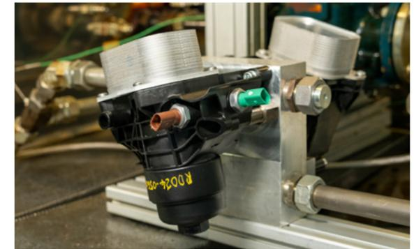
Die Ölfiltermodule werden auf Prüfständen umfangreich getestet.
