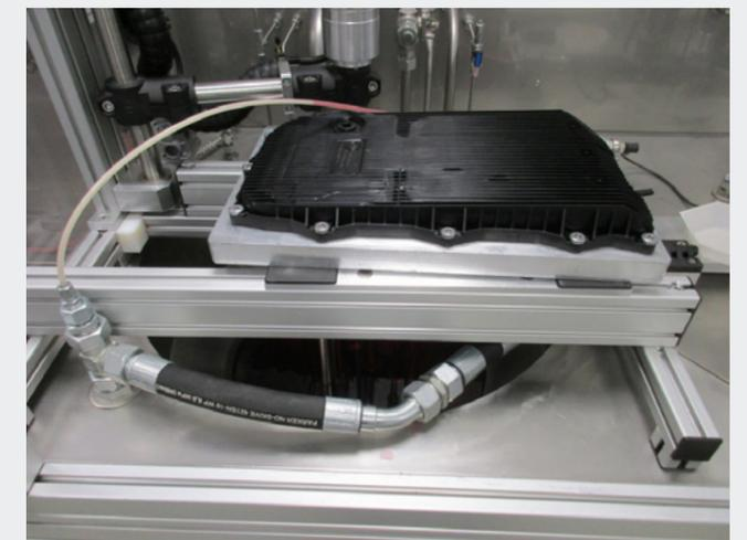
Prüfstand zur Ermittlung der Filtereffizienz und Staubhaltekapazität
