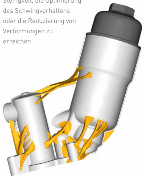
Das orange dargestellte Optimierungsergebnis dient dem Konstrukteur zur Vorlage für Verstärkungsmaßnahmen.
